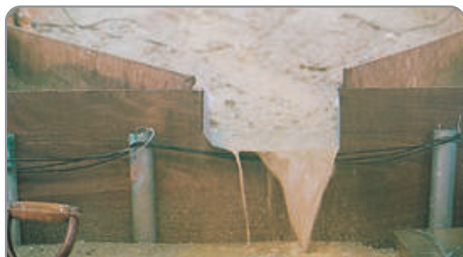
一般の植生シート 濁水が発生している
