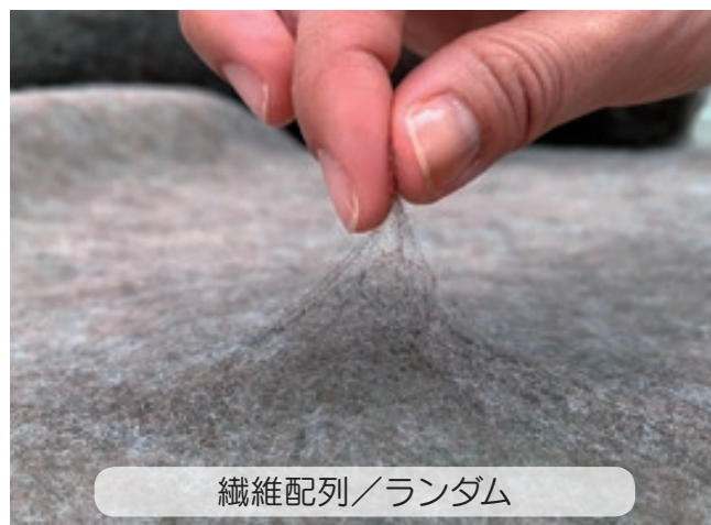
ウェブ (高空隙捲縮性ポリプロピレン製不織布)
